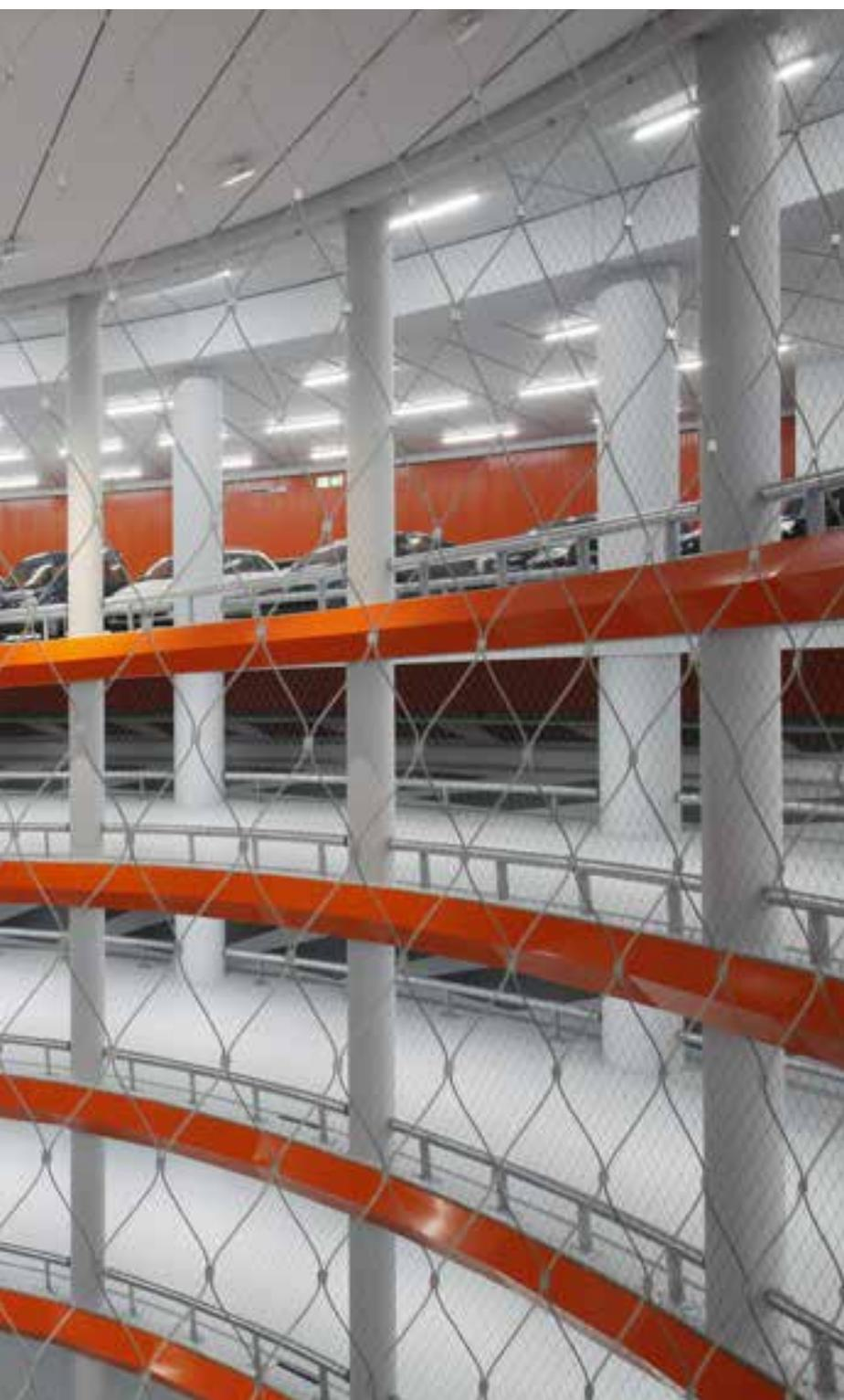
I-SYS Edelstahlseile und X-TEND Seilnetze sind eine leichte und transparente Möglichkeit der Absturzsicherung. Durch die hohe Transparenz ist eine flächendeckende Sicherung ohne oder mit nur geringer Einschränkung der Sicht sowie mit hoher Licht- und Luftdurchlässigkeit möglich. Durch das geringe Gewicht können sie im Gegensatz zu massiven Gebäudeverkleidungen auch in der Leichtbauarchitektur angewendet werden.
